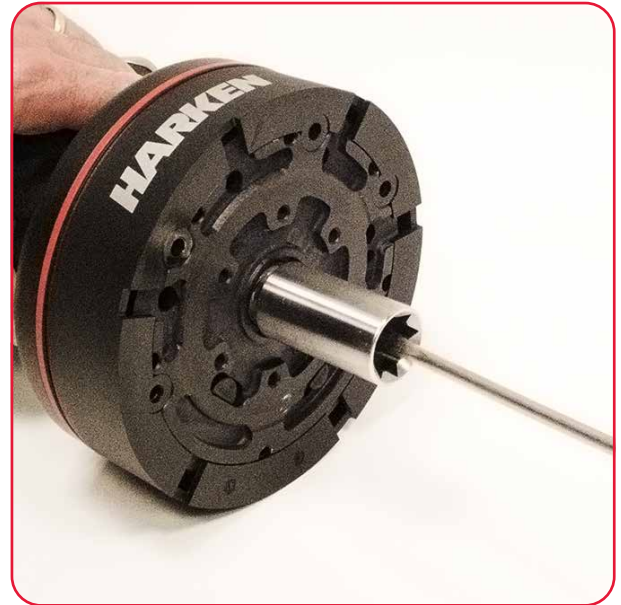
5 Lås skruven på handtagskopplingen.
