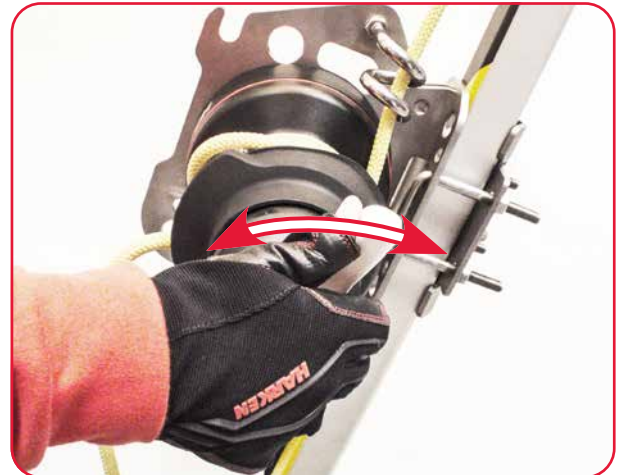
Kontrollera att semi-blockskivans kontrollspak fungerar korrekt genom att vrida och släppa den.
